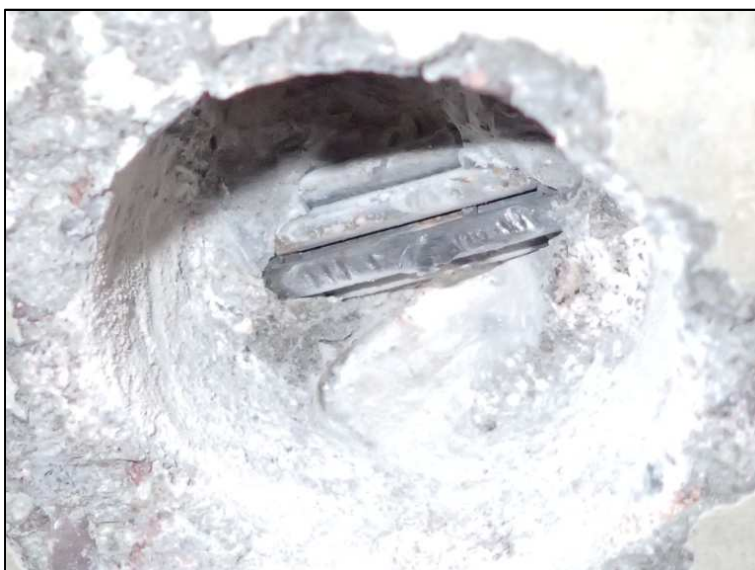
Obrázek 48 - sonda D12, výztuž bez koroze, kanálek zainjektovaný
