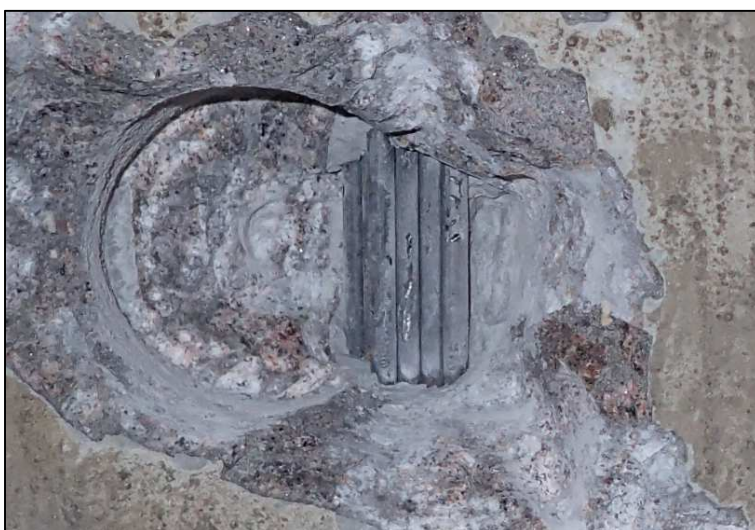
Obrázek 39 – sonda D3, výztuž bez koroze, kanálek zainjektovaný
