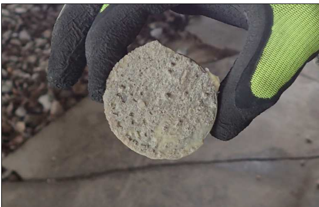
Obrázek 27 - odtržený terč, porušení, místo 4-1
