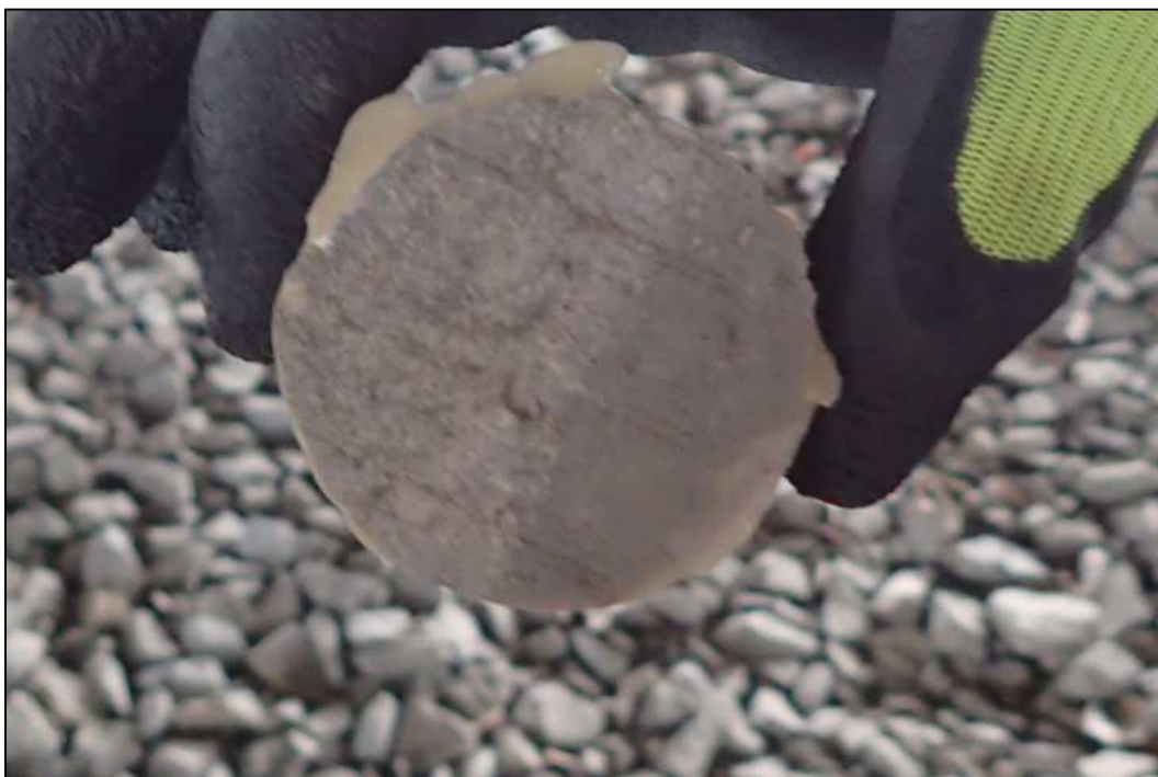
Obrázek 26 - odtržený terč, porušení, místo S 3-3
