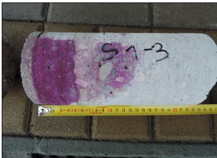
Obrázek 12 – – výnos z vrtu S 1-3 s fenolftaleinovým testem
