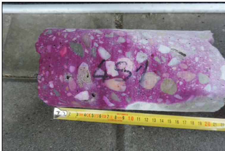
Obrázek 16 – výnos z vrtu S 4-1 s fenolftaleinovým testem
