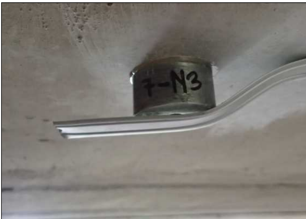
Obrázek 25 – nalepený terč na dolním líci konstrukce s fixací
