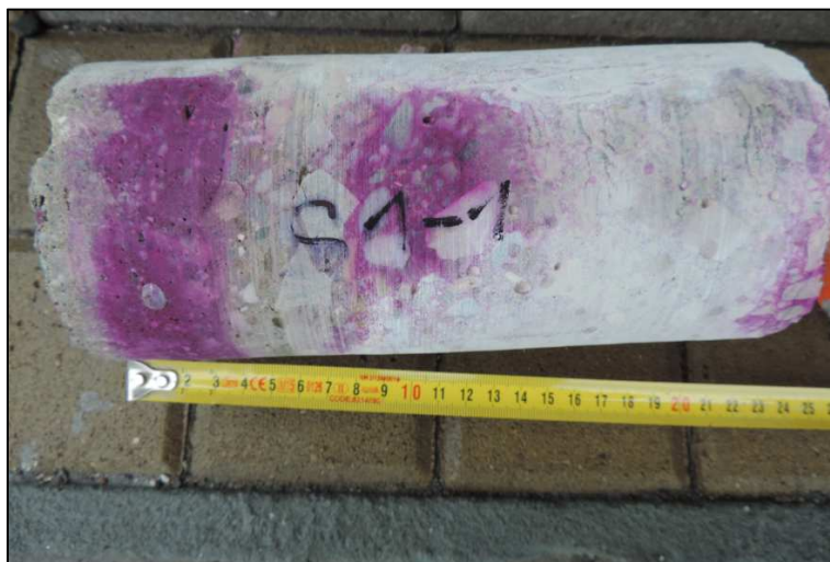
Obrázek 10 – výnos z vrtu S 1-1 s fenolftaleinovým testem
