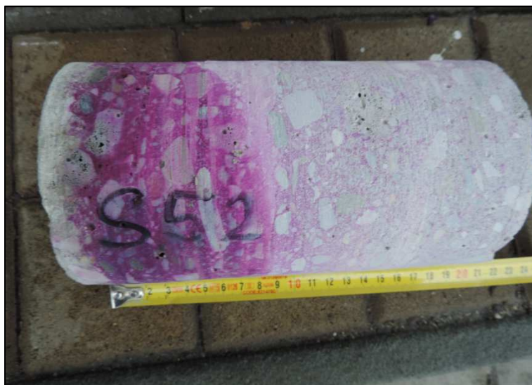
Obrázek 20 – výnos z vrtu S 5-2 s fenolftaleinovým testem
