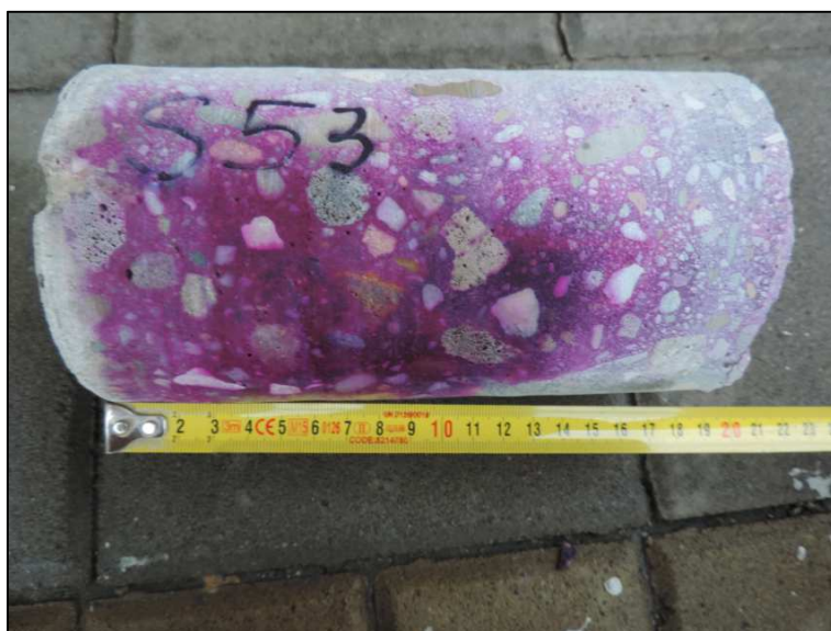
Obrázek 21 – výnos z vrtu S 5-3 s fenolftaleinovým testem
