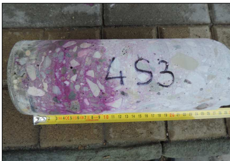
Obrázek 18 – výnos z vrtu S 4-3 s fenolftaleinovým testem
