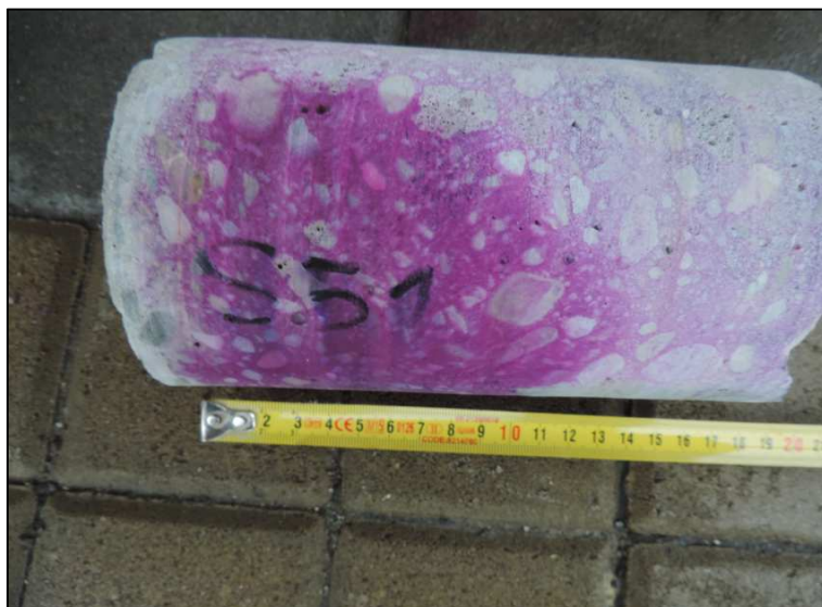
Obrázek 19 – výnos z vrtu S 5-1 s fenolftaleinovým testem
