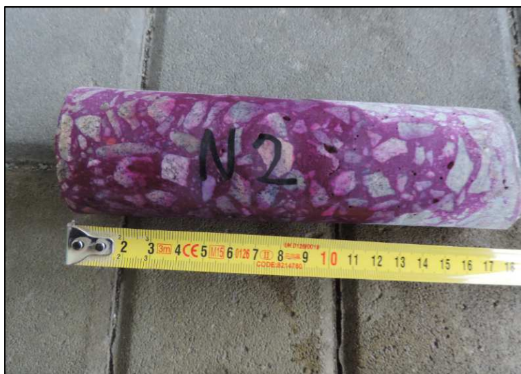
Obrázek 8 – výnos z vrtu N2 s fenolftaleinovým testem
