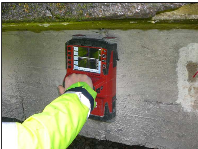
Obrázek 29 - Hilti PS1000 01X Concrete Pulse Radar
