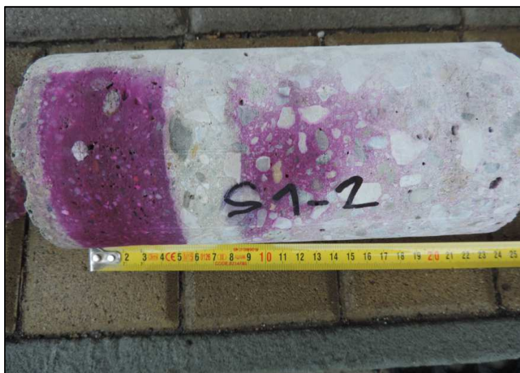
Obrázek 11 – – výnos z vrtu S 1-2 s fenolftaleinovým testem
