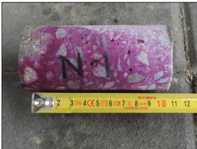
Obrázek 7 – výnos z vrtu N1 s fenolftaleinovým testem
