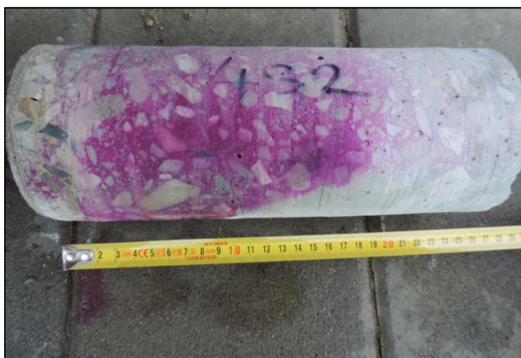
Obrázek 17 – výnos z vrtu S 4-2 s fenolftaleinovým testem
