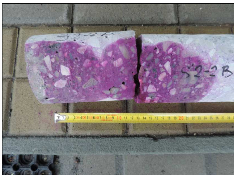
Obrázek 14 – výnos z vrtu S 2-2 s fenolftaleinovým testem
