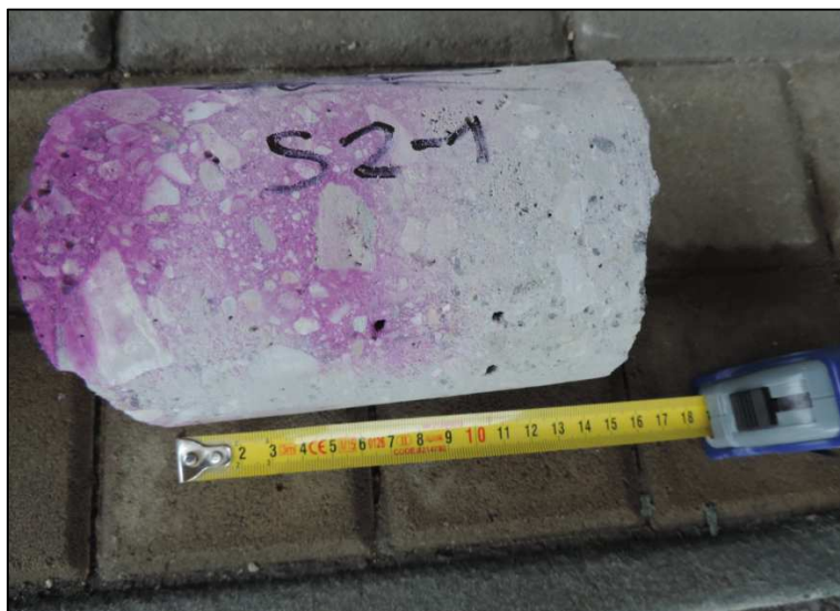
Obrázek 13 – výnos z vrtu S 2-1 s fenolftaleinovým testem
