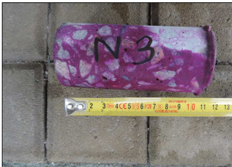
Obrázek 9 – výnos z vrtu N3 s fenolftaleinovým testem
